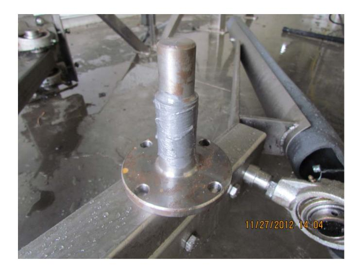
• REMOVE EXIT END SPINDLE FROM OLD BRUSH. APPLY ANTI SEIZE ON SHAFT.
